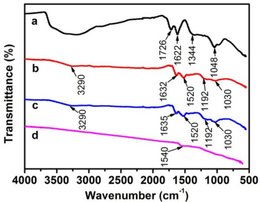
**Fig. S-2.** Fourier transform infrared spectra of (a) CGO, (b) DNMG-1, (c) DNMG-2, and (d) CG.
