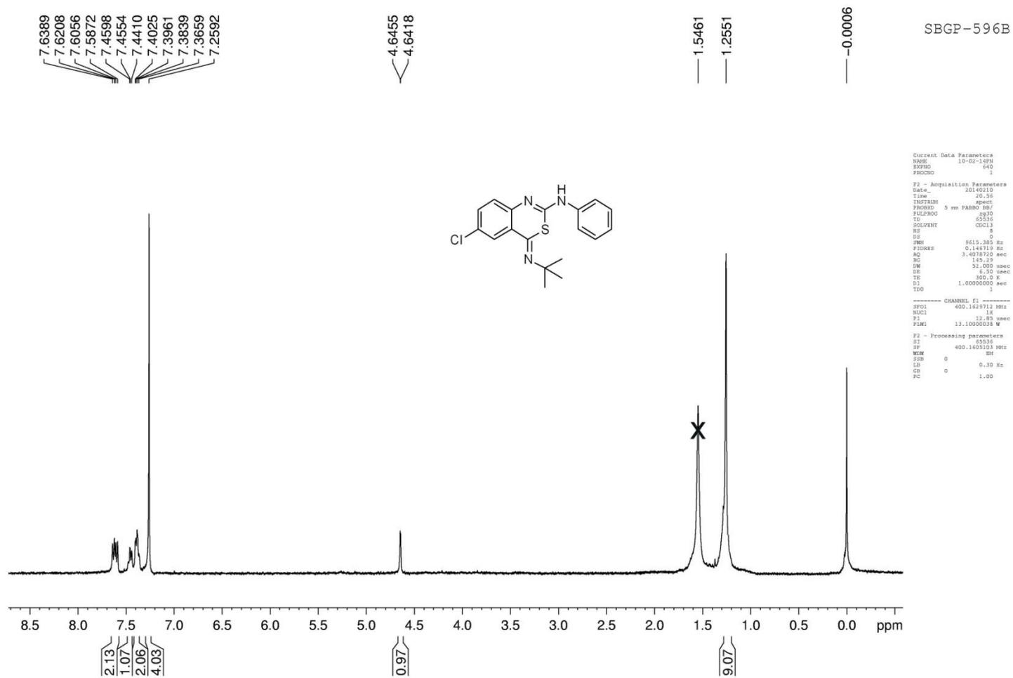
**Fig:S-30**  $^1\text{H}$  spectrum of *(Z)*-4-(*tert*-Butylimino)-6-chloro-*N*-phenyl-4*H*-benzo[*d*][1,3]thiazin-2-amine (**3kB**)
