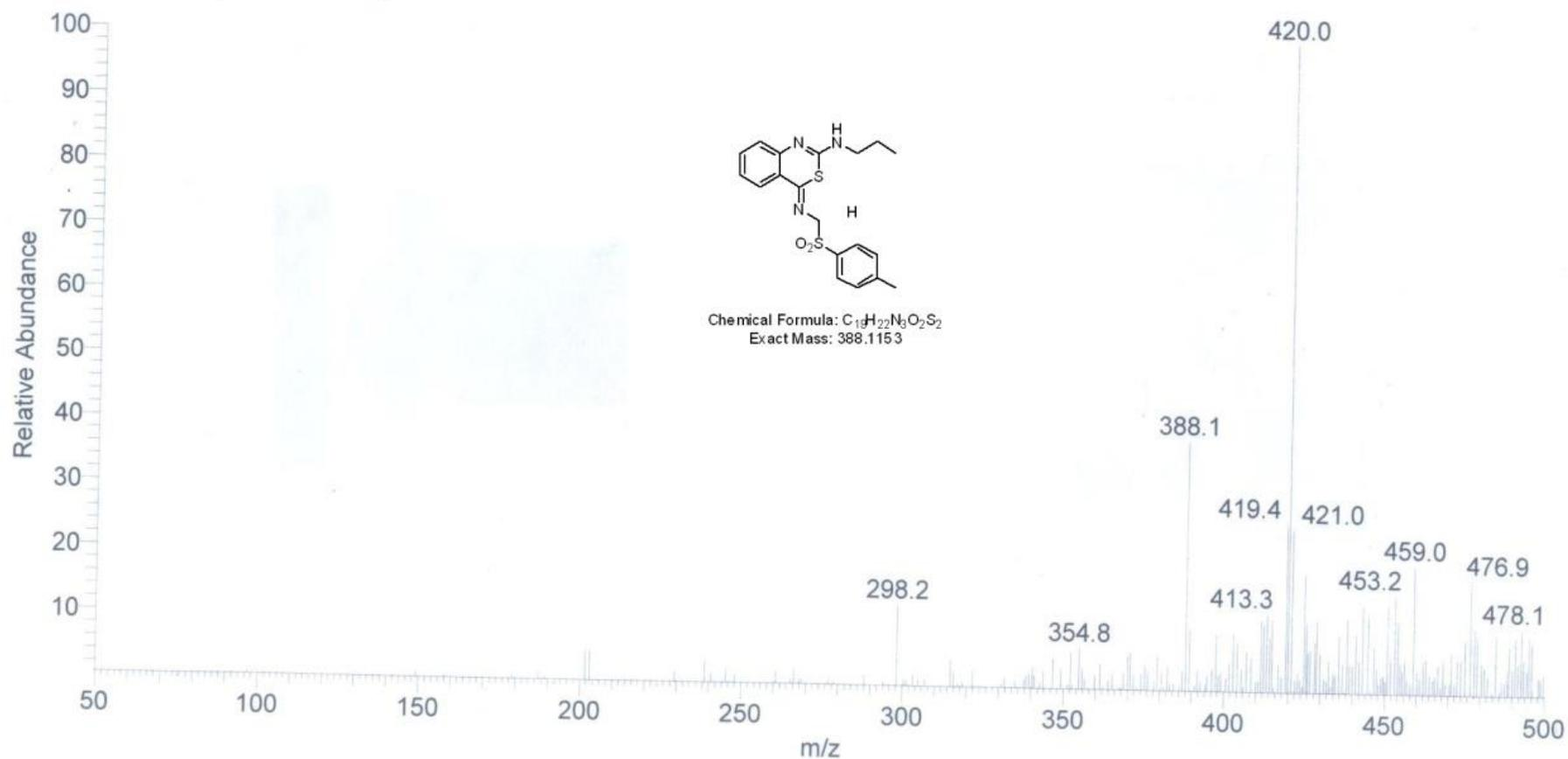
**Fig: S-56** ESMS spectra of (Z)-4-(phenylsulfonylmethylimino)-N-propyl-4H-benzo[d][1,3]thiazin-2-amine (**3gC**) (crude product)
