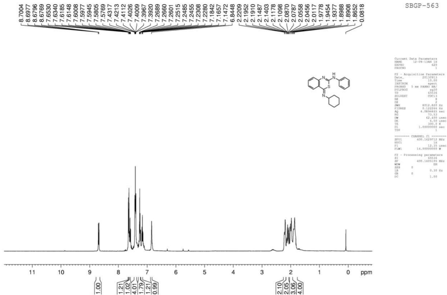
**Fig: S-1**  $^1\text{H}$  spectrum of (Z)-4-(Cyclohexylimino)-N-phenyl-4H-benzo[d][1,3]thiazin-2-amine (**3aA**)
