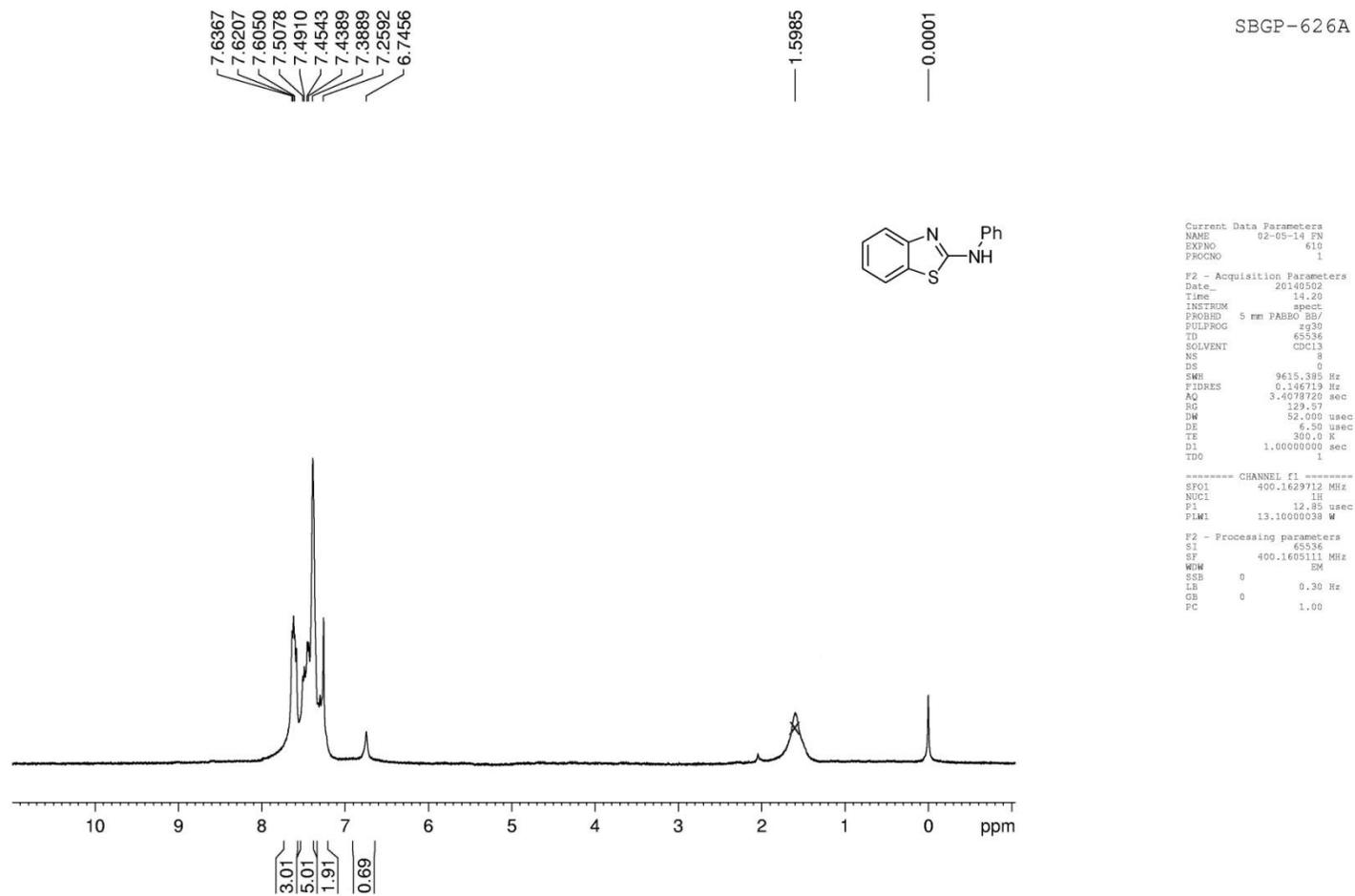
**Fig: S-52**  $^1\text{H}$  spectrum of *N*-Phenylbenzo[*d*]thiazol-2-amine (**4a**)
