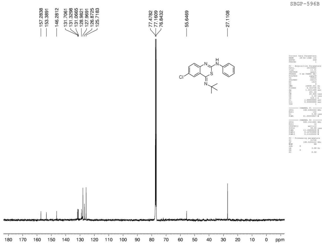
**Fig: S-31**  $^{13}\text{C}$  spectrum of (*Z*)-4-(*tert*-Butylimino)-6-chloro-*N*-phenyl-4*H*-benzo[*d*][1,3]thiazin-2-amine (**3kB**)
