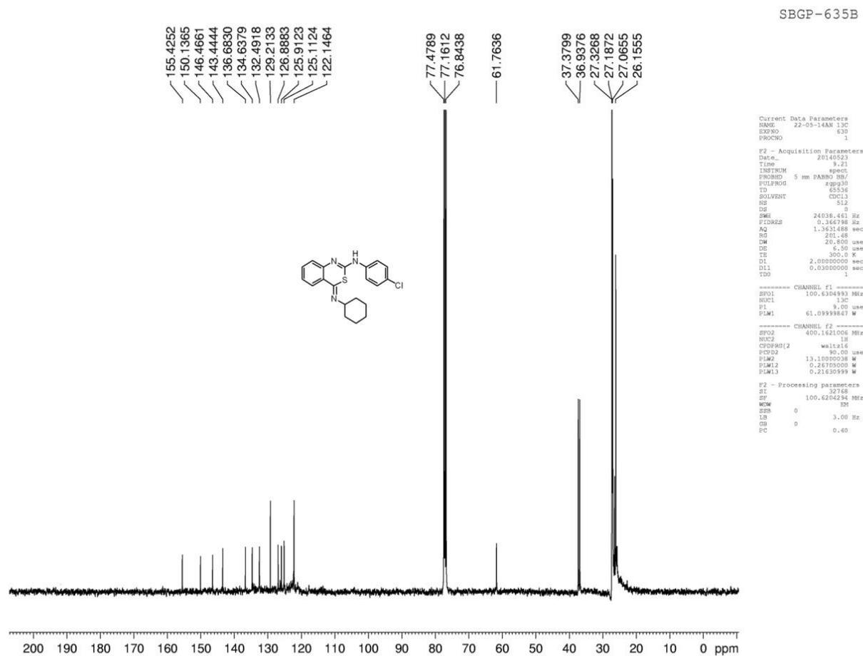
**Fig: S-7**  $^{13}\text{C}$  spectrum of *(Z)*-*N*-(4-Chlorophenyl)-4-(cyclohexylimino)-4*H*-benzo[*d*][1,3]thiazin-2-amine (**3cA**)
