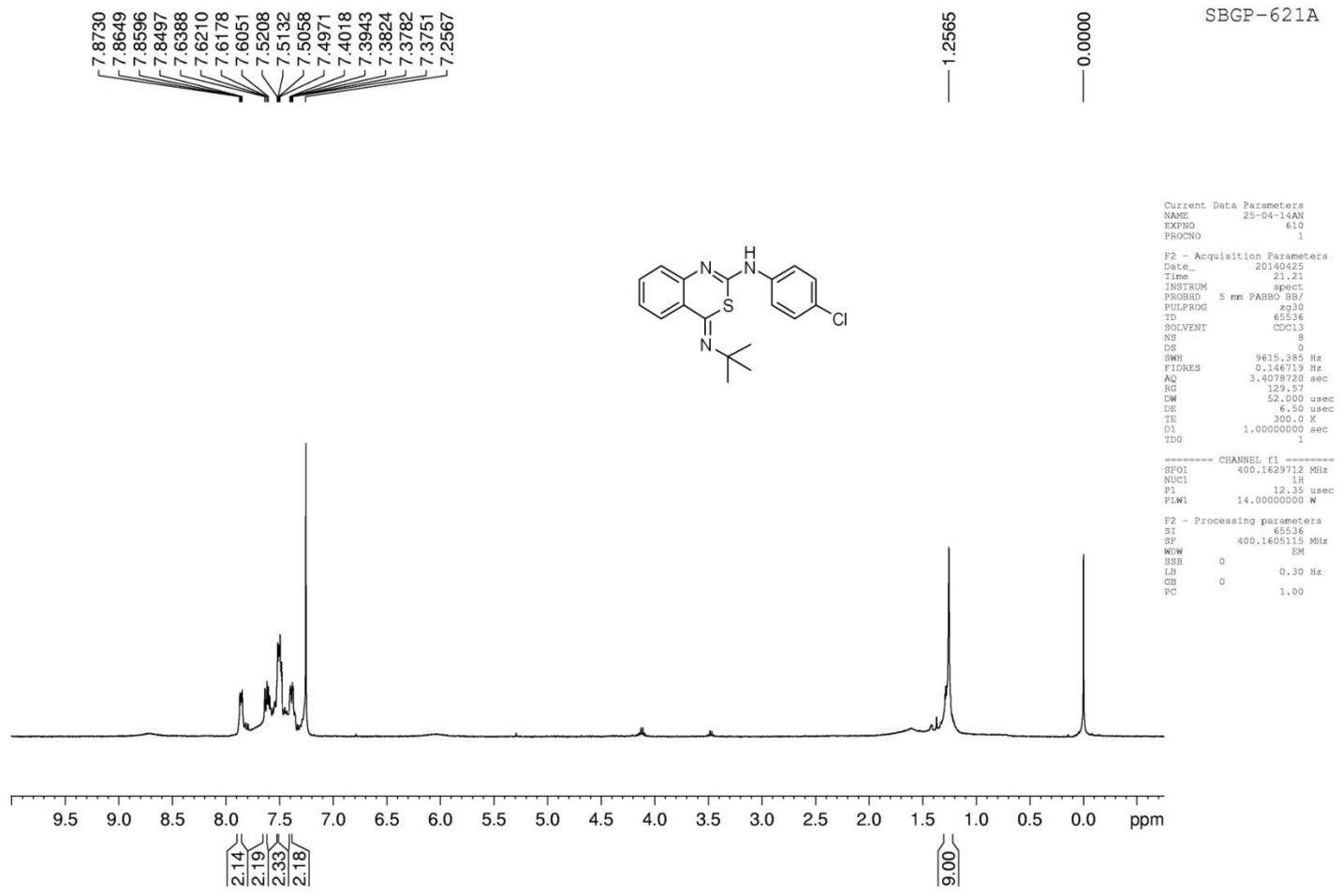
**Fig: S-26** <sup>1</sup>H spectrum of (Z)-4-(tert-butylimino)-N-(4-chlorophenyl)-4H-benzo[d][1,3]thiazin-2-amine (**3cB**)
