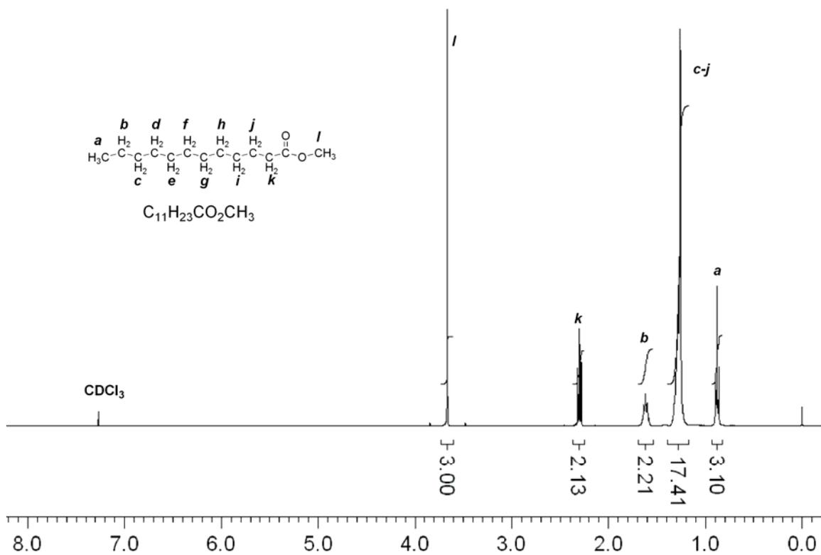
Figure S7.  $^1H$  NMR ( $CDCl_3$ ) spectrum of  $C_{11}H_{23}CO_2CH_3$ .
