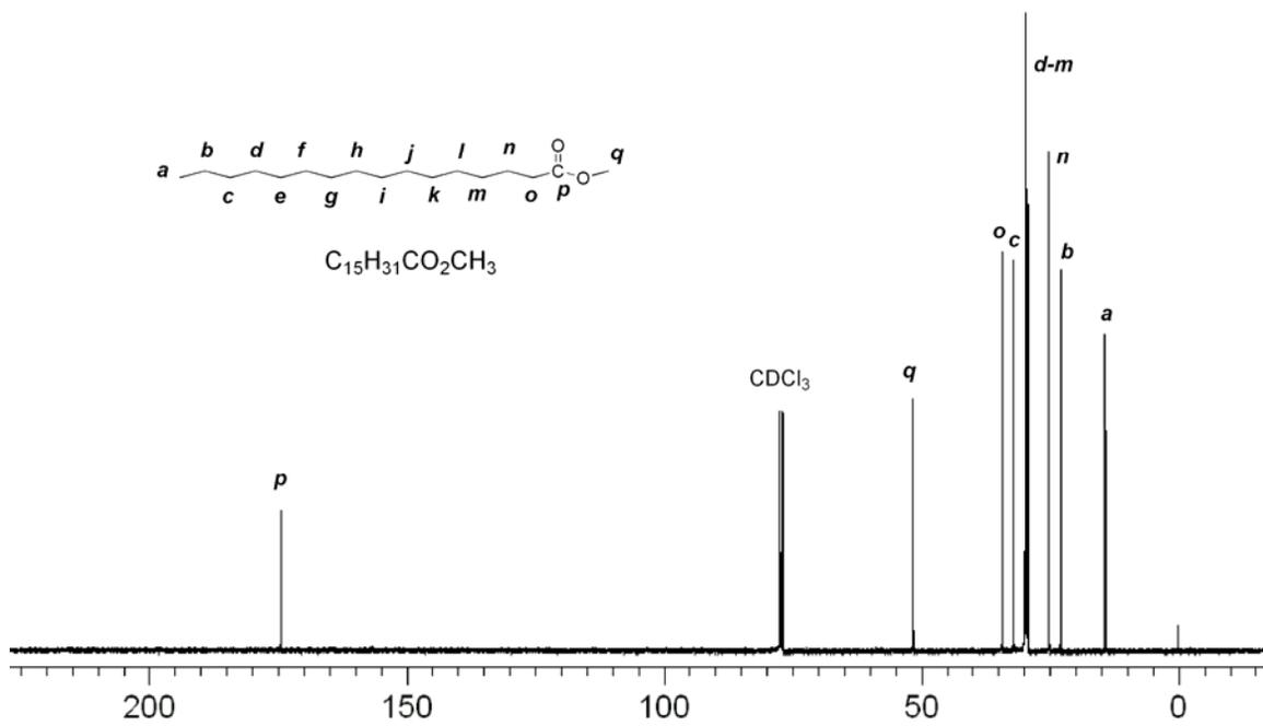
Figure S12.  $^{13}C$  NMR ( $CDCl_3$ ) spectrum of  $C_{15}H_{31}CO_2CH_3$ .
