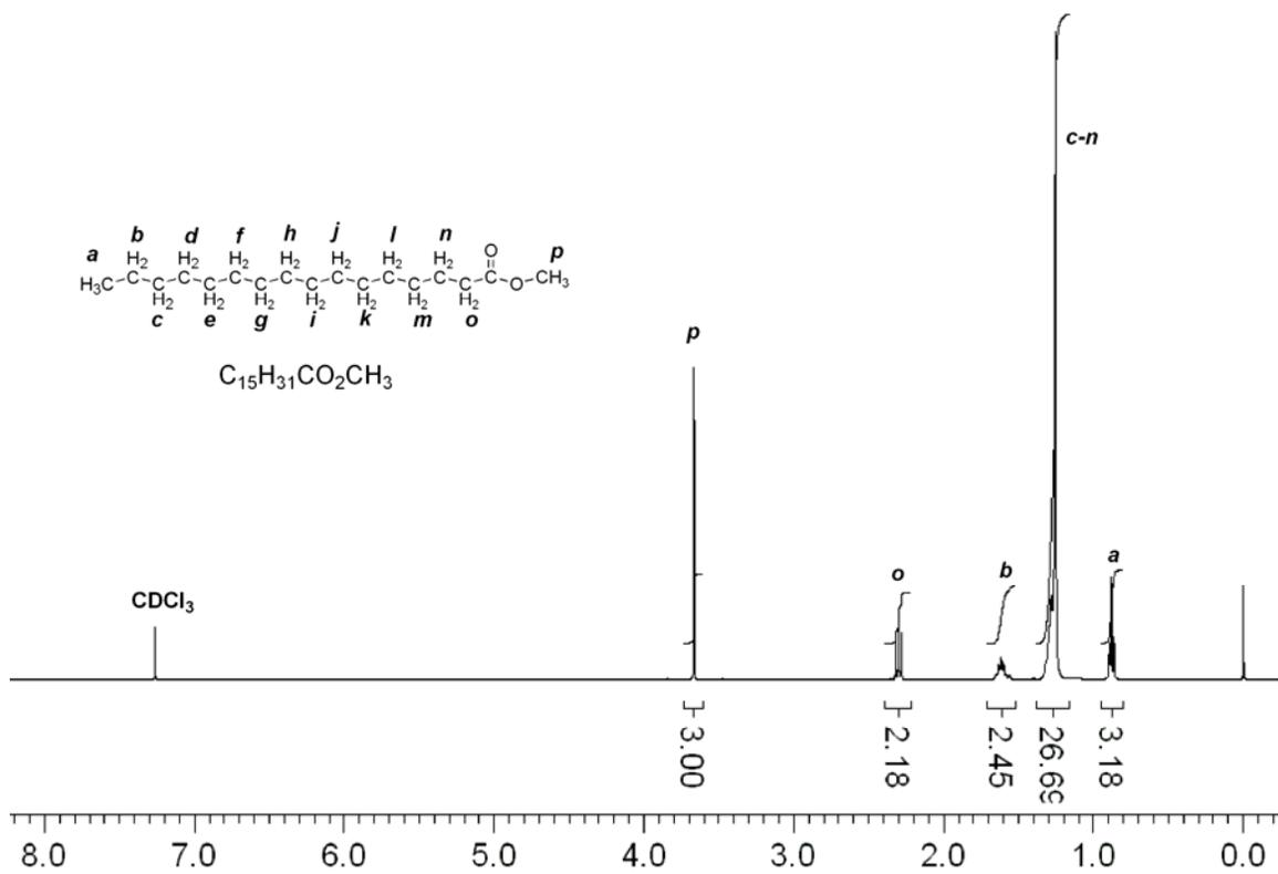
Figure S11.  $^1H$  NMR ( $CDCl_3$ ) spectrum of  $C_{15}H_{31}CO_2CH_3$ .
