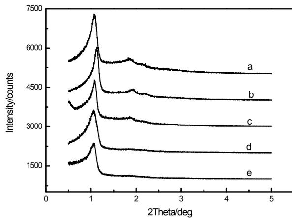
**Fig. S2** XRD patterns for (a) MA-1, (b) MA-2, (c) MA-3, (d) MA-4 and (e) MA-5
