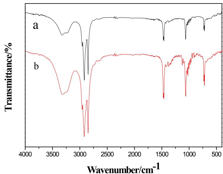
Fig. S7 FTIR spectra of (a) 1-octadecanol, (b) PCM-3
