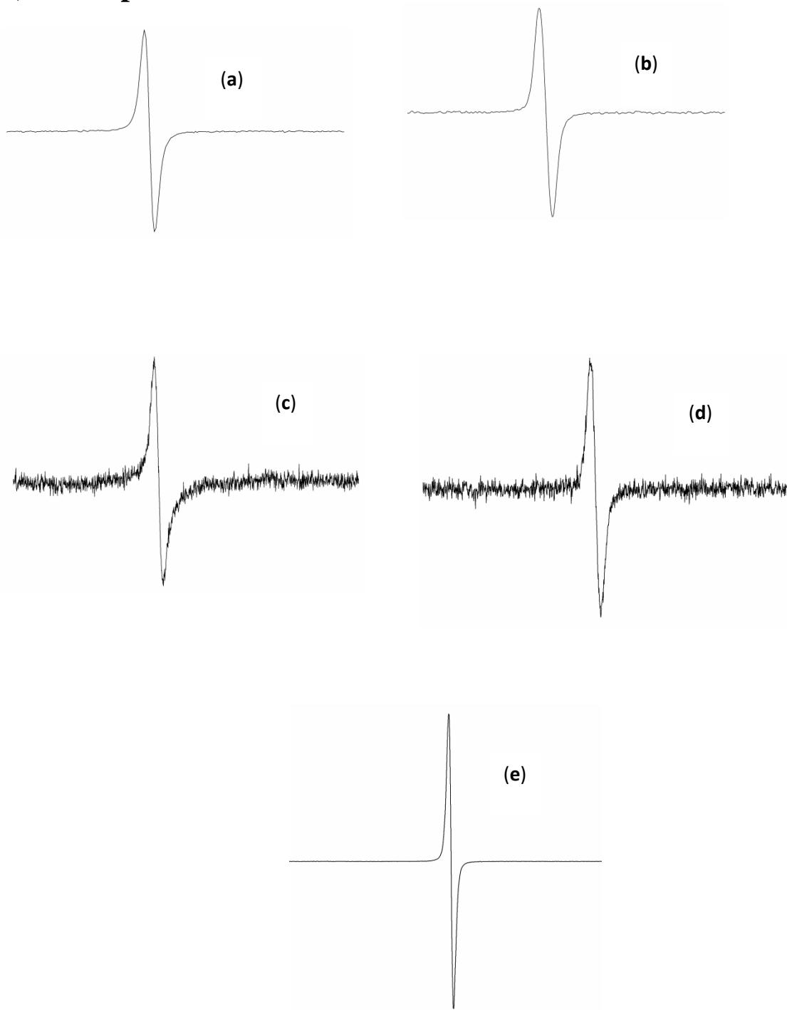
**Figure S8.** X-band EPR spectra of  $\mathbf{1}^+$  ( $10^{-3}$  M) recorded at: (a) 293 K. (b) 167 K. (c) 8 K. (d) 8 K ( $10^{-5}$  M) (e) 293 K (after 5 equiv oxidant)
