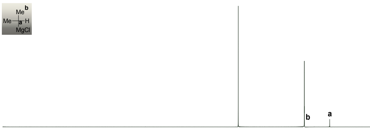
Figure S 4. No deuterium ^{13}\text{C} NMR of iPrMgCl in THF ( c \approx 1.75\text{M} ).
