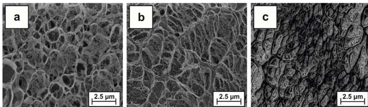
**Figure S1:** Cryo-FESEM images of a) **sPEOPO**<sub>10</sub>, b) **sPEOPO**<sub>15</sub> and c) **sPEOPO**<sub>20</sub> SN.
