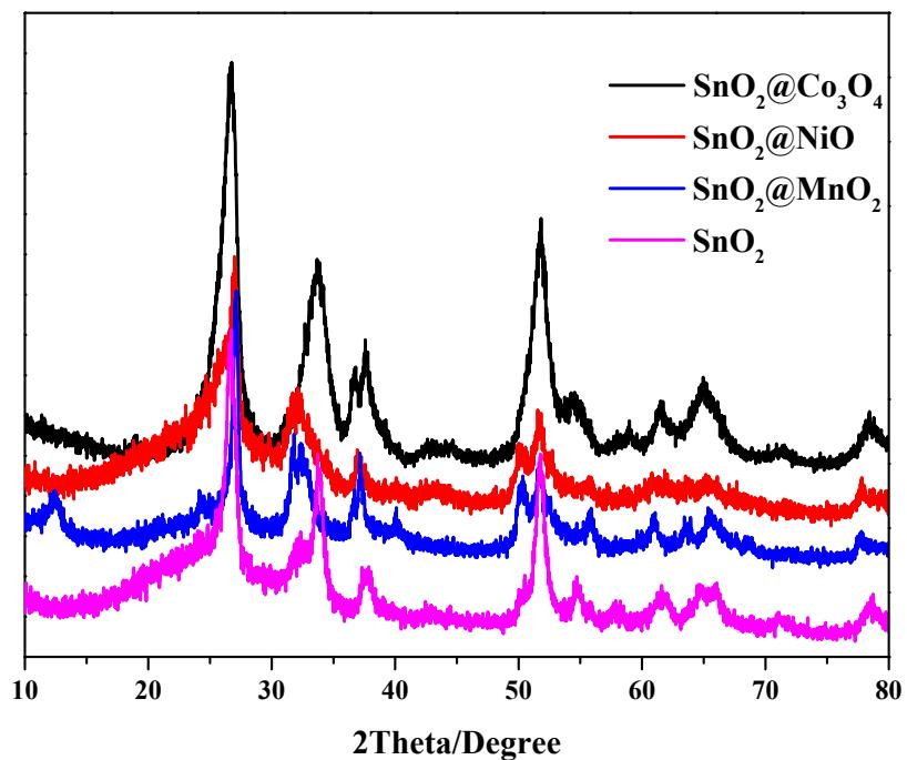
Figure S2. XRD patterns of (a)  $\text{SnO}_2$ , (b)  $\text{SnO}_2@\text{MnO}_2$ , (c)  $\text{SnO}_2@\text{Co}_3\text{O}_4$ , (d)  $\text{SnO}_2@\text{NiO}$ .
