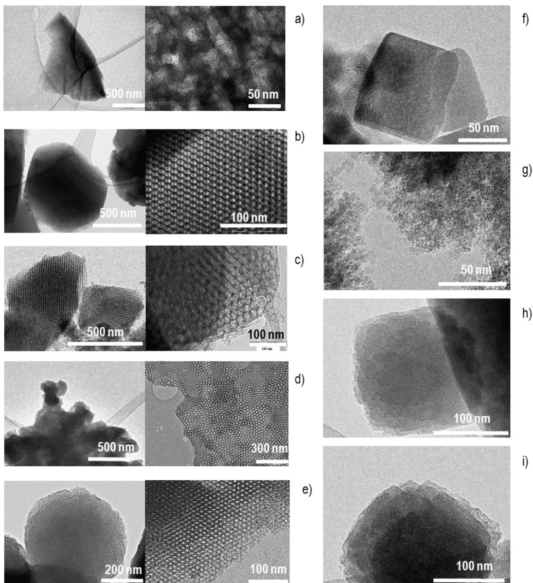
**Figure S2:** TEM images of mesoporous materials: a) MCM-41; b) SBA-15; c) SBA-EXP; d) FDU-12 and e) SBA-16), and zeolitic materials: f) ZSM-5; g) h-ZSM-5; h) Beta and i) h-Beta).
